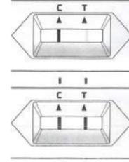
2. Das Vorhandensein einer Testlinie (T) zusammen mit einer Kontrolllinie (C) bedeutet ein positives Ergebnis.
